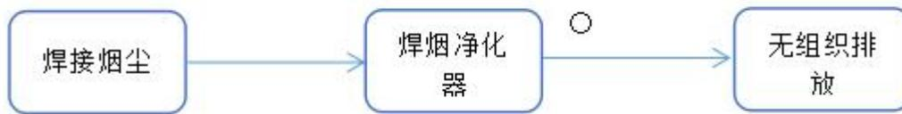
图 3-2 焊接废气排放流程图
